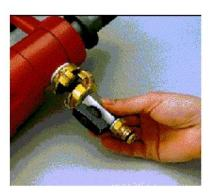
При необходимости сверления с водой подсоедините водяной кран к входной муфте мотора. Подключите машину к водопроводу через кран.
